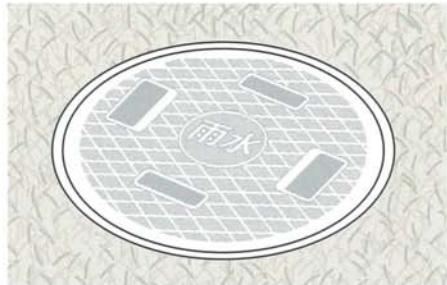
雨水樹は、雨樹やバルコニーなどから流れてくる雨水の中継地点です。雨水の配管の合流部分や、放流方向が変わるところに設置されることが多く、落ち葉や泥、砂などを沈殿させて、配管を詰まりにくくする役割があります。そのため、溜まったゴミを取り除き、掃除をする必要があります。浸透樹の場合、目詰まりを起こし、浸透機能が作用しなくなる恐れがあります。
