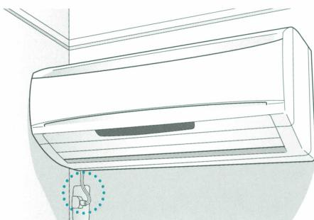
床暖房の電源は、エアコンの室内機から取っています。床暖房を使用する際も、コンセントを抜かないでください。
