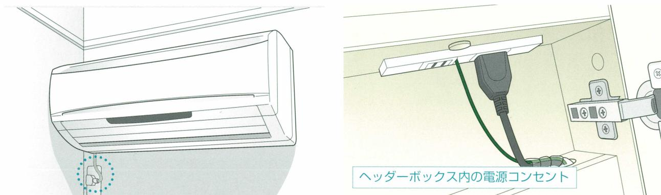
暖房オフシーズンでも、自動的に循環水の循環をする機能があります。室内機から電源を取っているため、室内機、およびヘッダーボックス内のコンセントは抜かないでください。また、ヘッダーボックス内の元栓は締めずに開放したままにしてください。
