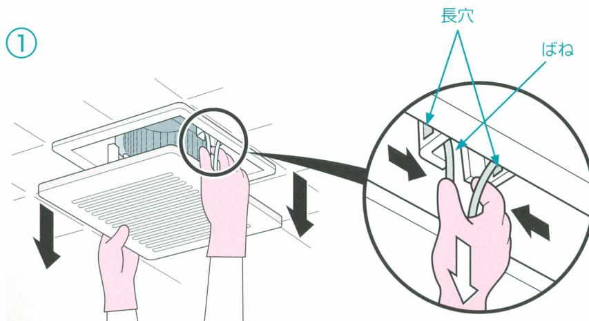
ルーバーを少し下げ、ばねをせばめて本体の長穴（左右2か所）からはずします。（ホコリの落下に気をつけてください）
