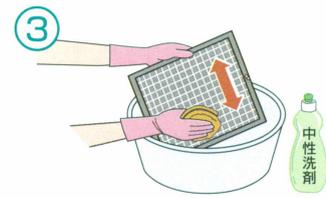
③ 中性洗剤を溶かしたぬるま湯に浸し、フィルターの目にそって樹脂製たわし等で洗ってください。
