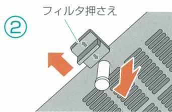
② フィルターの取っ手を持ち、フィルタ押さえを手前にスライドさせて外します。
